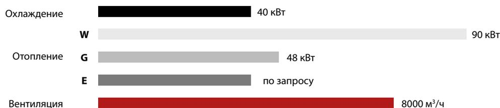
W - с водяным обогревом (мощность для теплоносителя 70/50°C, температура воздуха перед теплообменником 8°C)
