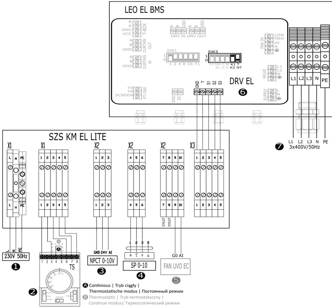
1. Power supply (min. 3x1,5 mm<sup>2</sup>) | Zasilanie (min. 3x1,5 mm<sup>2</sup>) | Stroomvoorziening (min. 3x1,5 mm<sup>2</sup>) | питание 230V/50Hz (мин. 3x1,5 mm<sup>2</sup>)
