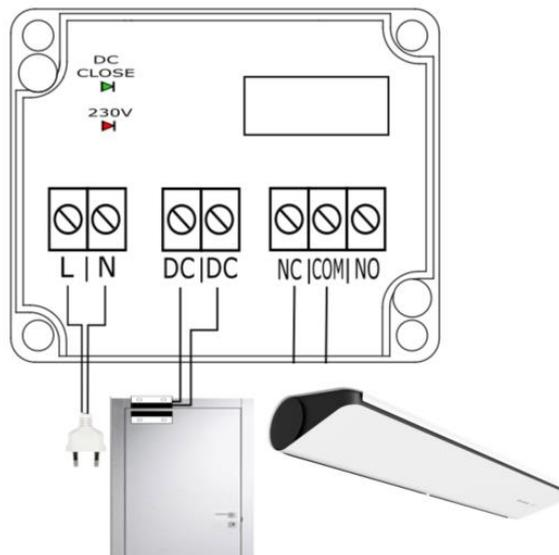
**3. WIRING DIAGRAM | AANSLUITSCHEMA | SCHEMAT PODŁĄCZENIA | СХЕМА ПОДКЛЮЧЕНИЯ**
