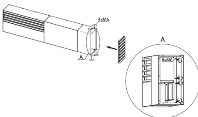
Montaż side duct and grill.
