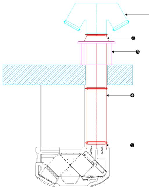
① OxS-H- Czerpnia dachowa | OxS-H- roof-mounted air inlet/outlet | OxS-H –dak afwerkkap luchtinlaat/uitlaat | OxS-H – крышная установка для забора/выброса воздуха
