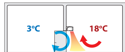
De deur gaat 60 seconden open. Luchttemperatuurmeting met het luchtgordijn AAN.
