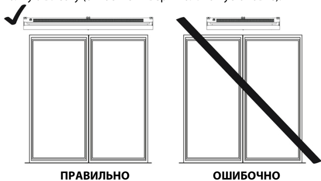
РИС. 7.1 ПРАВИЛЬНАЯ ГОРИЗОНТАЛЬНАЯ УСТАНОВКА.
