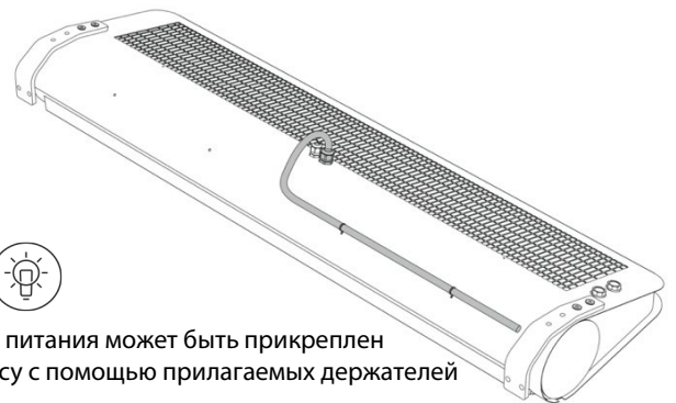
РИС. 11.6 ПРОКЛАДКА КАБЕЛЯ ВОКРУГ КОРПУСА
