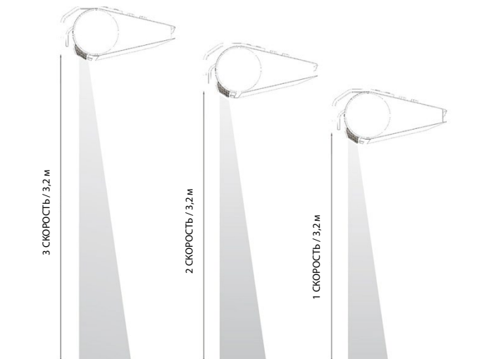
РИС. 2.2 ДЛИНА ПОТОКА ВОЗДУХА НА КАЖДОЙ СКОРОСТИ.
