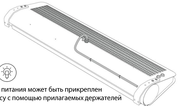
РИС. 11.6 ПРОКЛАДКА КАБЕЛЯ ВОКРУГ КОРПУСА
