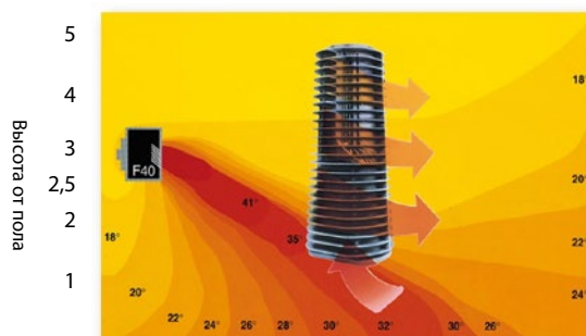
Термография показывает принцип действия эффекта земля „Robur”
