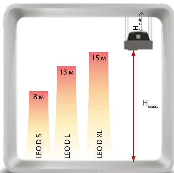
$H_{\text{макс}}$  – максимальная высота монтажа для дестратификаторов, измеряемая от лопастей установленных вертикально
