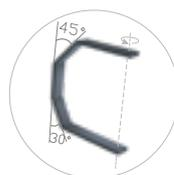
**Поворотная консоль** позволяет установить аппарат вертикально или горизонтально к перегородке.
