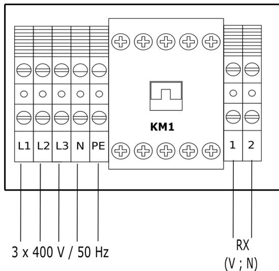
Wires size should be chosen by the designer / Przekrój i typ przewodu powinien zostać dobrany przez projektanta / Kabeldiameter moet door de ontwerper worden vastgelegd / Сечение и тип проводов должен быть подобран проектировщиком
