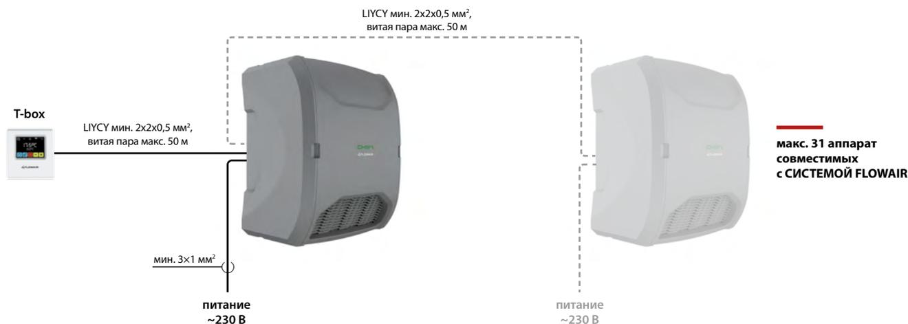
Аппарат в стандартной комплектации оснащен полным комплектом управления и защитной автоматикой. Контроль параметров работы осуществляется с помощью контроллера T-box.
