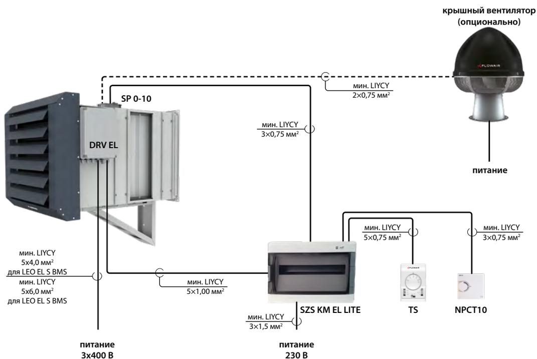
**АВТОМАТИКА КМ EL LITE** - комплектная система питания и управления для LEO EL S/L BMS + КМ EL S/L. В комплект входят:
