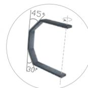
**Поворотная консоль** позволяет установить аппарат вертикально или горизонтально под разными углами к перегородке.
