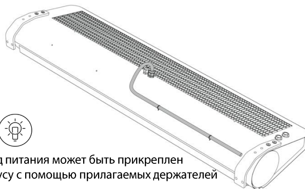
РИС. 11.6 ПРОКЛАДКА КАБЕЛЯ ВОКРУГ КОРПУСА
